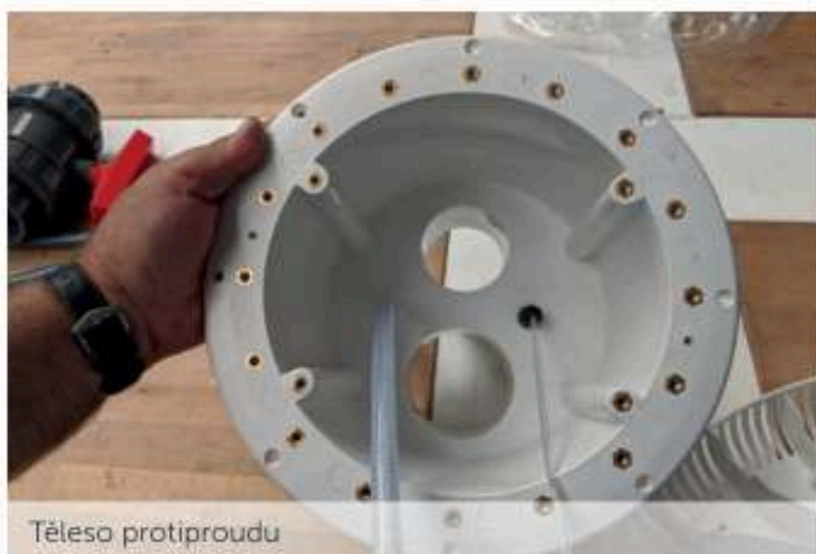
Vývod spinací hadice z tělesa protiproudu přes redukci do ochranné hadice
