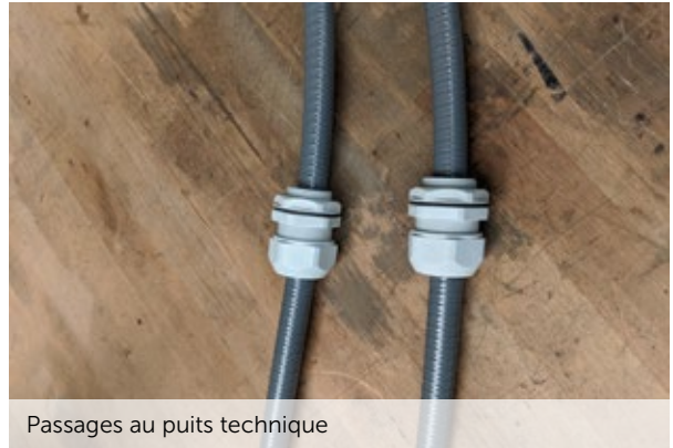
Sortie du tuyau de commutation du corps à contre-courant via la réduction au tuyau de protection
